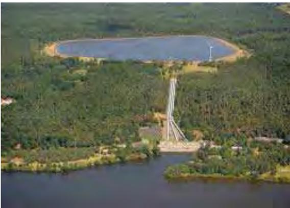
**Pumpspeicherwerke müssen in Zeiten mit überschüssigem Strom unter viel Verlust Wasser in einen höher gelegenen See pumpen. Zu Zeiten von Strommangel wird durch das Ablassen des Wassers in den niedrigeren See wieder Strom erzeugt. Nachteil: enormer Platzbedarf, in Deutschland sehr wenig vorhanden; sehr teuer, sehr lange Bauzeiten.**
